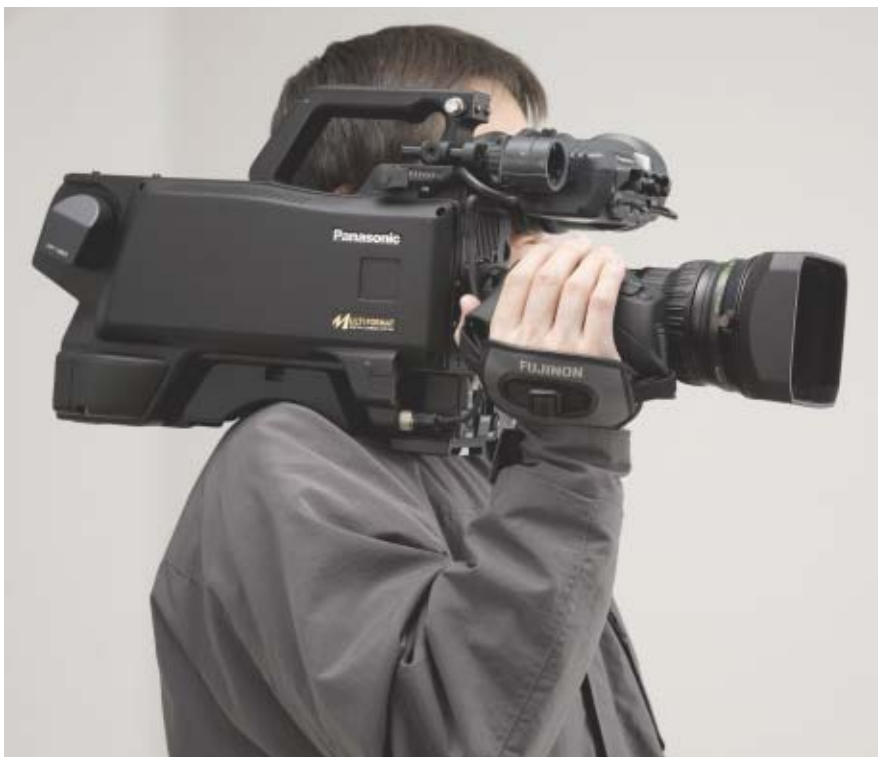
Risoluzione di 1100 linee per la Panasonic AK-HC3500, disponibile anche in versione da studio
